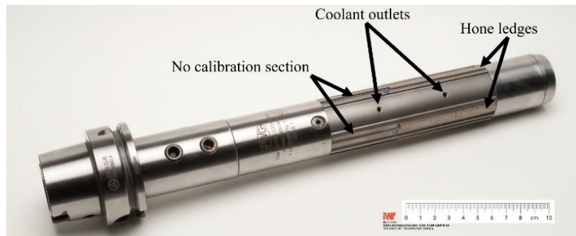
Fig. 2. Single-pass honing tool TH41-0/125-330-VH from PWG Präzisions-Werkzeugbau Geißler GmbH, Leutkirch, Germany
