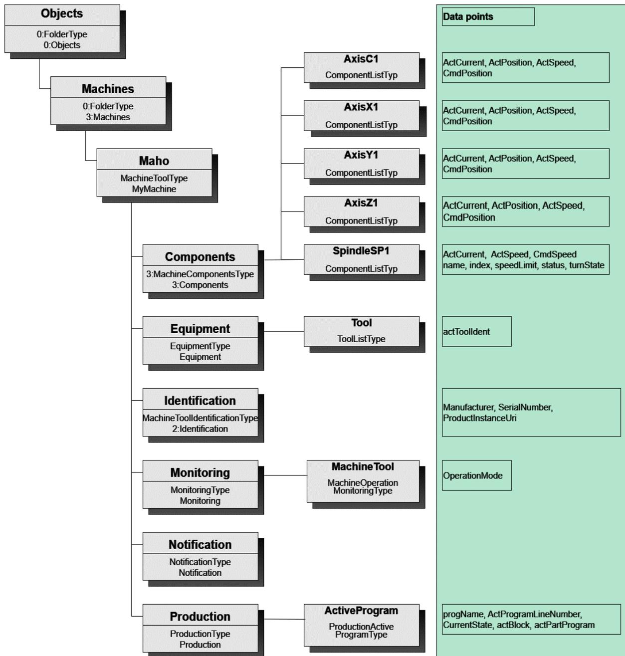
Fig. 2. OPC UA CS Machine Tool
